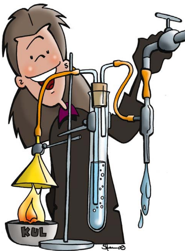
[1.12] Vandluftpumpen suger gasserne fra forbrændingen gennem CO 2 -indikatoren.
